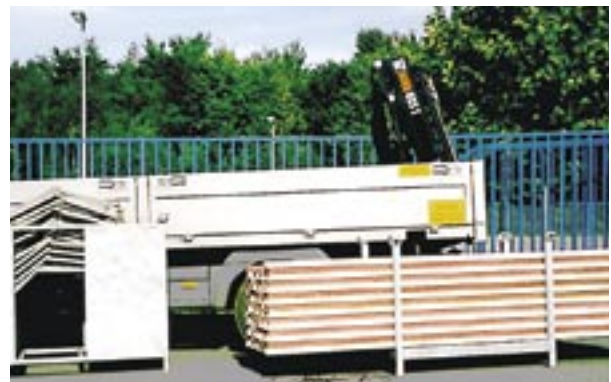
Systemelementen sorteras och läggs tillbaka i respektive ställning och transportbehållare ...
